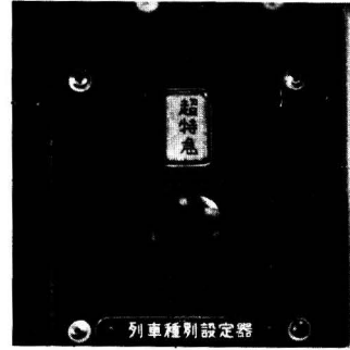
写真-2 列車種別設定器(大阪方運転台)
