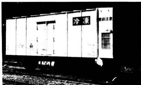
写真-1 冷凍機付冷蔵車(発電機式レ90)
