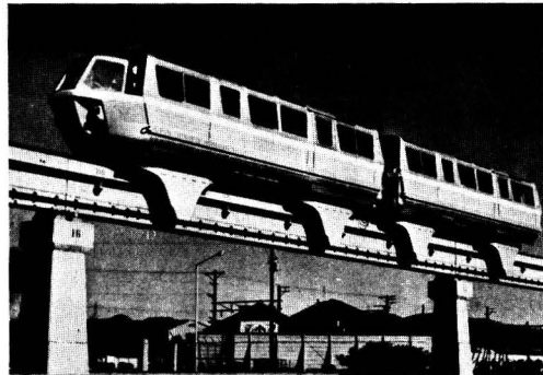
写真-6 跨座式（ロッキード式）モノレール（岐阜試験線で使用中）
