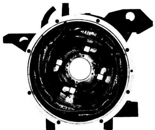
写真-2 MT 200 形主電動機固定子
