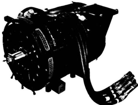
写真-1 MT 200 形主電動機外形
