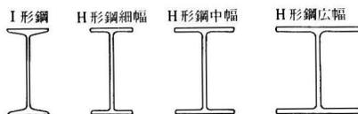
I形鋼がはり(梁)として有利な形であるのに対比、H形鋼は柱としても有利な形である。したがって、ウェブの厚さも相当厚いものが圧延されている。
