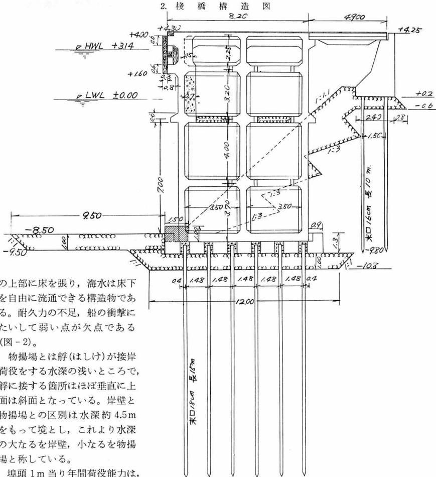
の上部に床を張り、海水は床下を自由に流通できる構造物である。耐久力の不足、船の衝撃にたいして弱い点が欠点である(図-2)。
