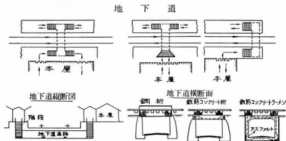
主として旅客用の通路で、中以下の駅では手小荷物通路を兼用するが多い。幅員は通過人員にもよるが、2m以上は必要で、通路床面より桁(けた)下までの空高も2m以上が必要である。また旅客の流れは出入口が最も混雑するので、地下道の階段口を広くするとか、あるいは両袖に設けることがある。手小荷物兼用の場合は、手小荷物は、エレベータを設けて乗降場と連絡する。旅客は階段で乗降場と連絡するのが一般的であるが、大駅ではエレベータやエスカレータを利用している例もあるが、建設費と経常費が多い難点がある。
