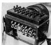
写真-3. 電動機型継電器
