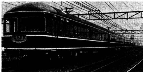
この特急形固定編成客車は、動くホテルとしての設備を凝らしたデラックス車両で、ナイトトレインにふさわしく、ノブルなブルーにクリーム色のライニングを施した軽量構造車両で、客室の設備も、すべてこの編成客車用として新しく、特に室内装飾の点では、デザインおよび色彩に従来の車両に見られなかった特色を発揮している。おもな共通の特徴として次のことがあげられる。
