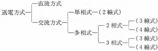
直流方式はつぎのように送電上有利な方式であるが、交流方式の機器以外に整流器・逆変流器が必要で、大電力長距離送電線路でないとは不経済となる。この他直流遮(しゃ)断器が技術的に未完成なので、まだ直流送電は一般には使われていない。(1) 直流では線路電圧が同一実効値の交流電圧最大値の $1/\sqrt{2}$ であるから、線路絶縁が容易になる (2) 率は常に1であるから送電効率が高い (3) 交流方式は送電電力に極限值があって、送電電力および距離がある程度以上となると送電不可能となるが、直流方式はその電線の電流容量だけで送電電力が決まる (4) ケーブルでは直流とすると絶縁を非常に簡単にできるので、海底ケーブルで送電する場合に実施された所がある。
