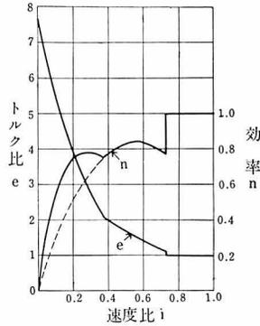
18. SRM形液体変速機性能曲線
