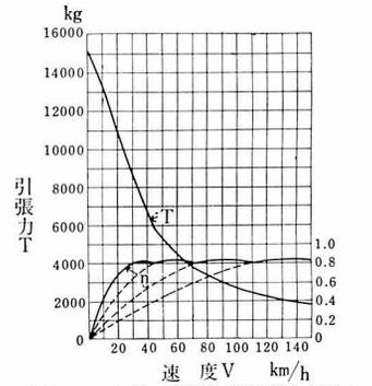
16. メキドロ形液体変速機を使用した1000HP(正味出力940HP)機関車の特性曲線
